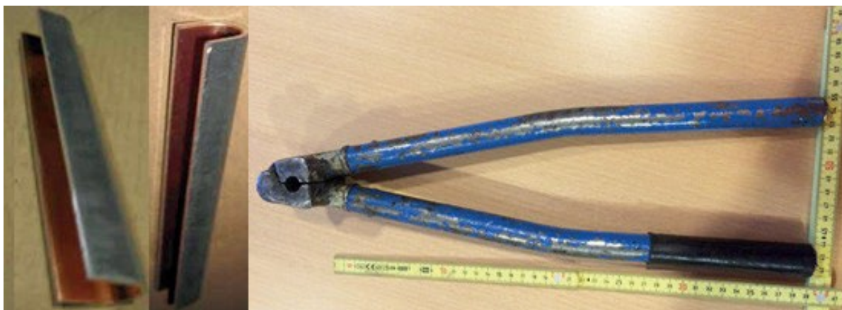
Figur 17.11 Cupalblikk og presstang
