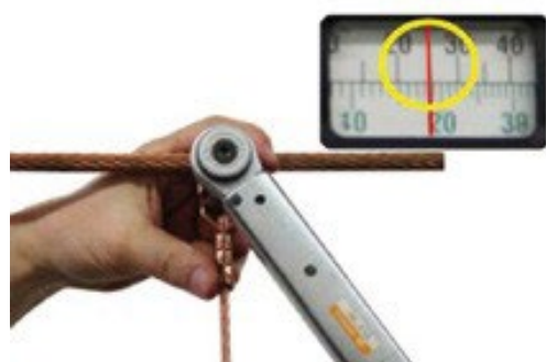
Figur 9.25 Bruk av momentnøkkel på hengetråd
