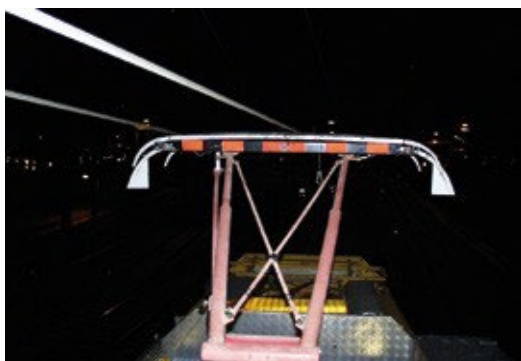
Figur 5.34 Riktig påløp av ledninger
