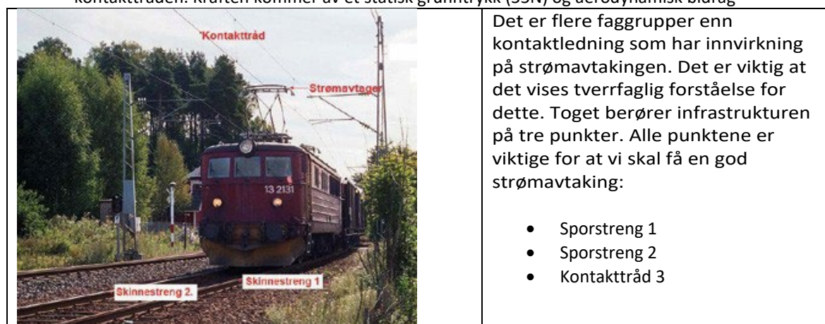
Figur 5.5 De tre punktene hvor trekraftmaterieell treffer infrastruktur
