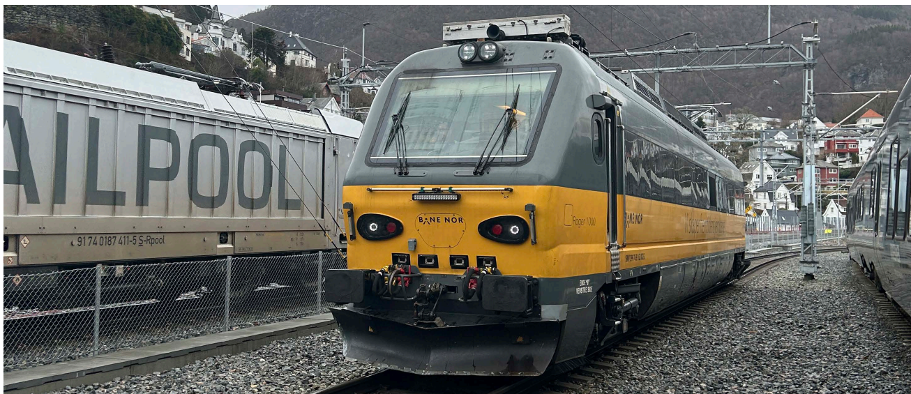
Målevognen til Bane NOR foretok nylig målinger av sporet og kontaktledningen fra Bergen stasjon til Arna, inkludert begge tunnelene gjennom Ulriken. Foto: Bane NOR/Edvard Folkedal-Holven
