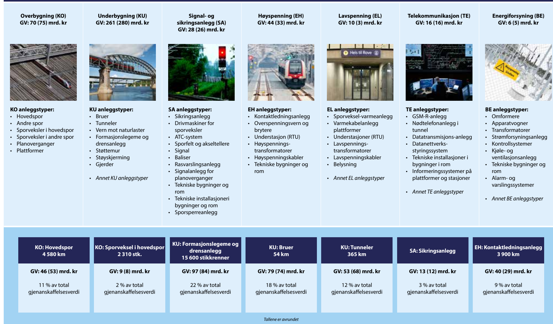
Figur 3: (Øverst) Jernbanens fagspesifikke anleggskategorier og underliggende anleggstyper med nøkkeltall og gjenanskaffelsesverdier (GV). (Nederst) Nøkkeltall og GV for hovedanleggstypene.
