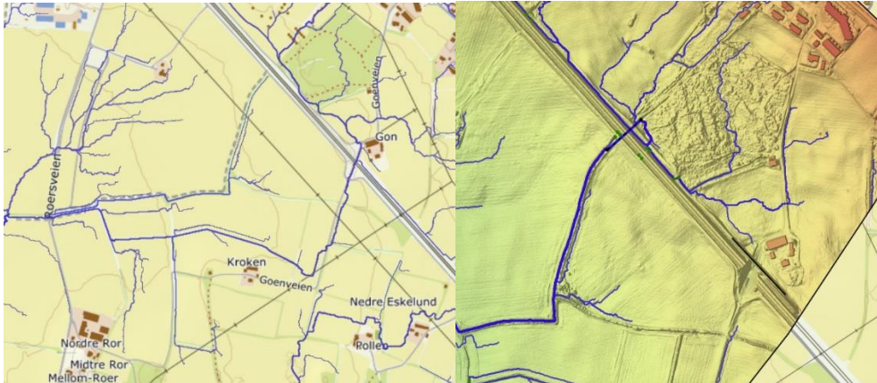
Fig 7 illustrerer vannveier for flom og overvann før og etter stenging av undergang ved Gon gård. Kilde: www.scalgo.com
