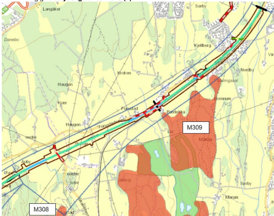
Figur 6-6 Kart med inntegnet verdi av larvikittområder nær utredningsområdet. I tillegg vises byggemetode, omlegging av veger og anleggsbelte.
