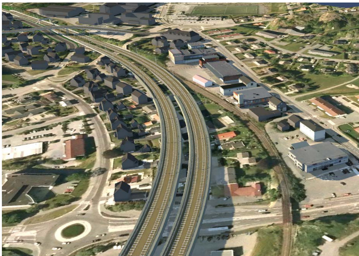
Figur 5-38. Mange bolighus mellom Sandefjordsveien og Bugårdsbakken blir berørt ved sporutvidelse og traséomlegging. Omlegging av Bugårdsbakken vil bli bearbejdet i senere planfaser med sikte på å finne en løsning som utløser mindre inngrep. Fra prosjektets arbeidsmodell sett i retning Larvik.
