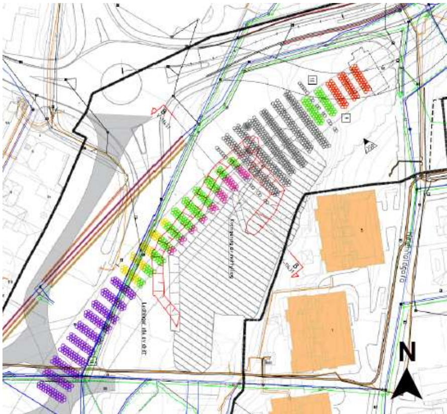
Figur 2-1 Omfang jetpeler og installert motfylling fra 2022 [1]
