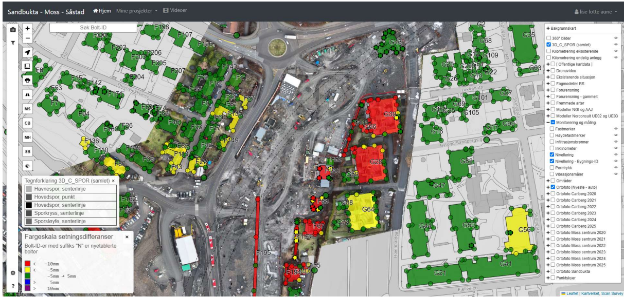
Figur 4-12 Oversiktskart over setningsinmålinger i nordre del av Kransen Nord (fra Scansurvey [18]). Hentet 2025-02-06.
