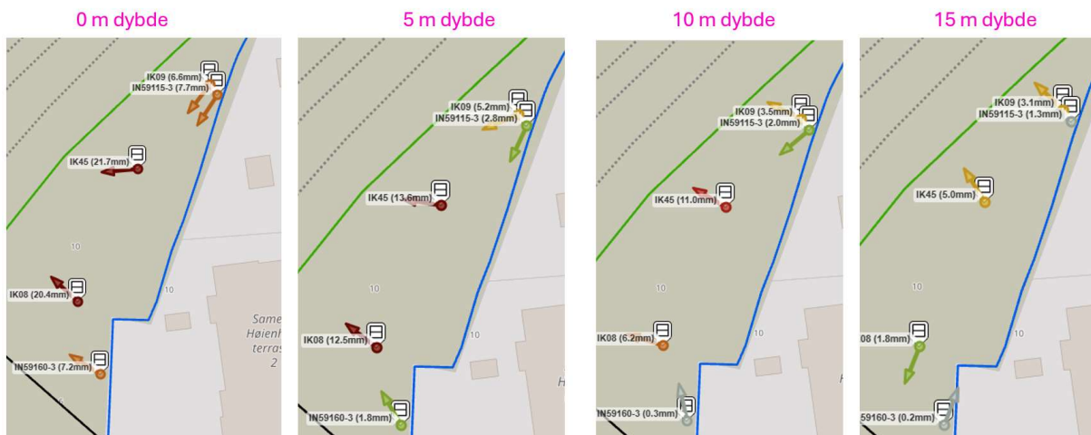
Figur 4-5 Deformasjonsmålinger som angir retning i de siste 6 månedene i 2024 i ulike dybder (fra NGI live)
