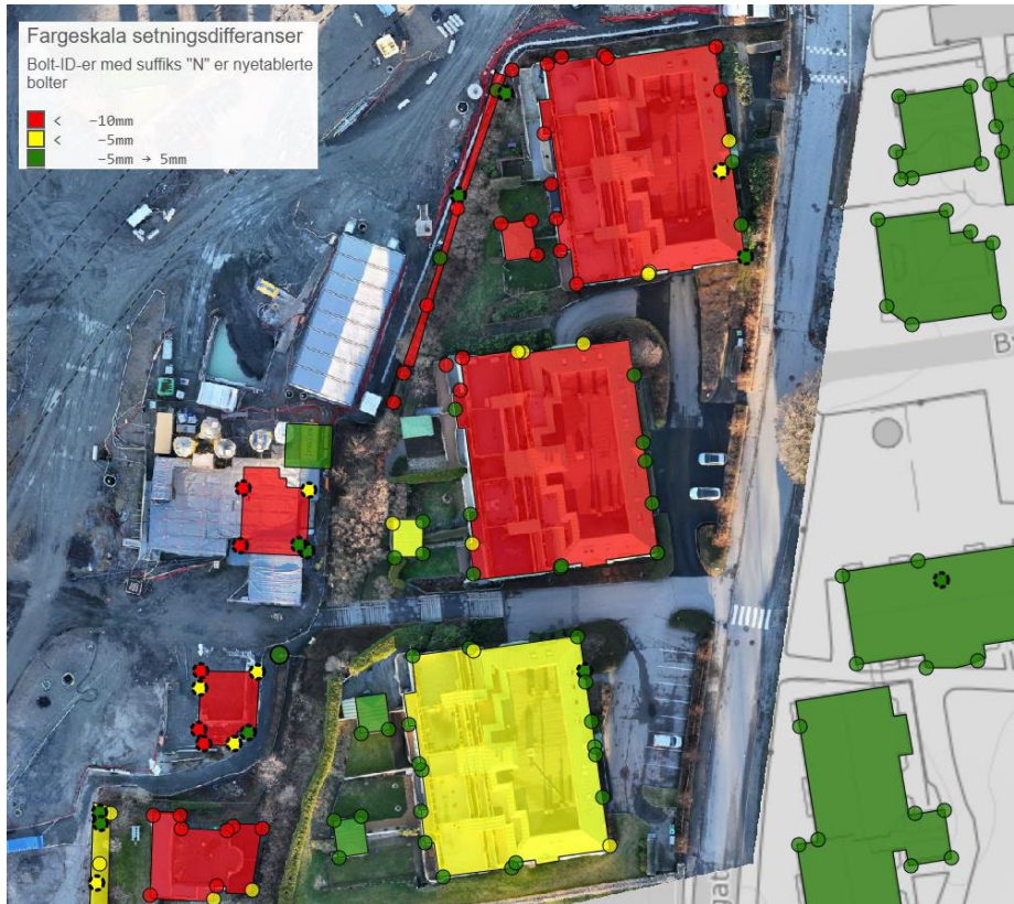
Figur 3-4: Setningsnivellement boligblokkene i Høienhaldgata
