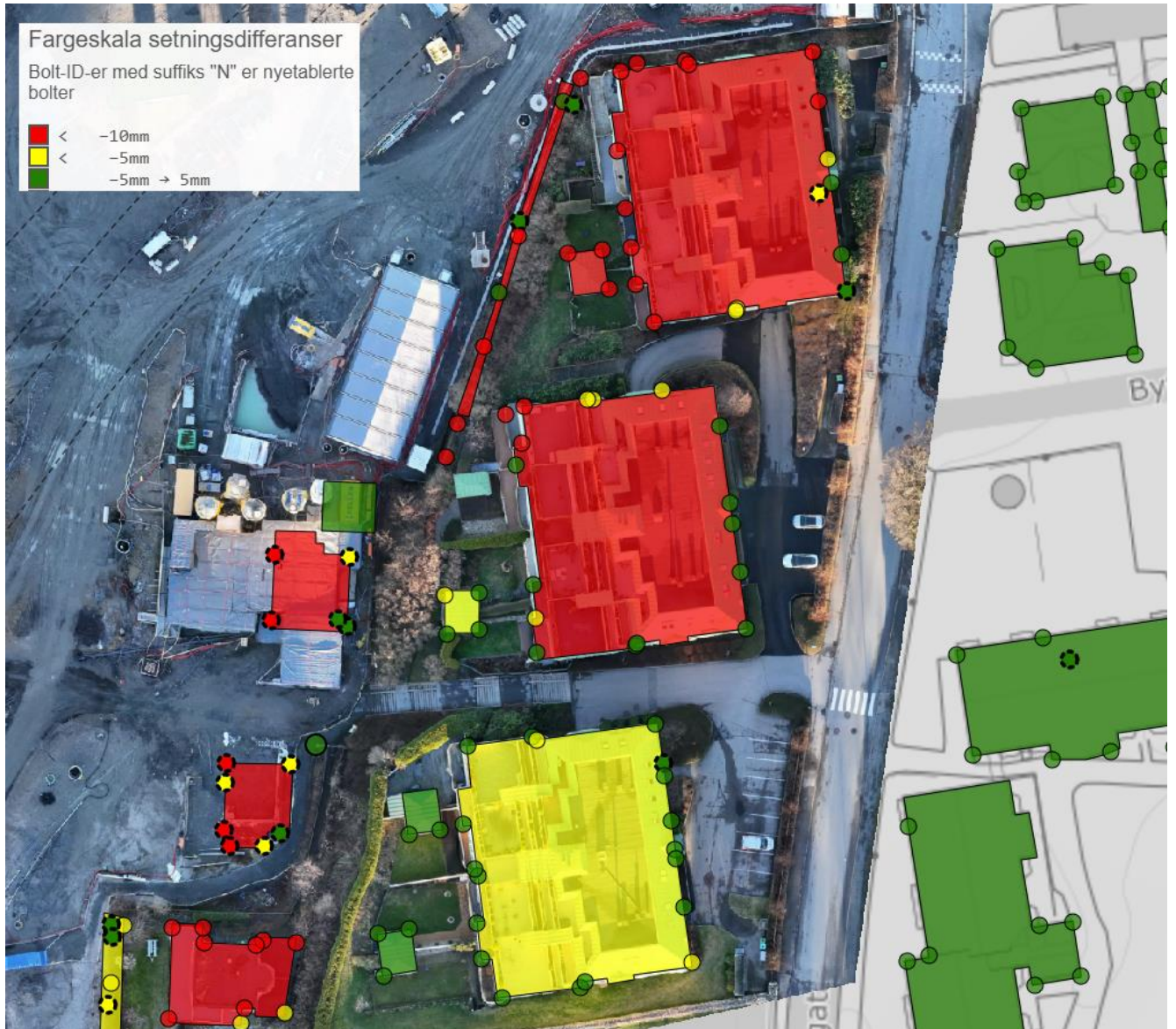
Figur 2-3 Setningsnivellement av innmåling av nordre fasade på Høyenhaldgata 5, desember 2024
