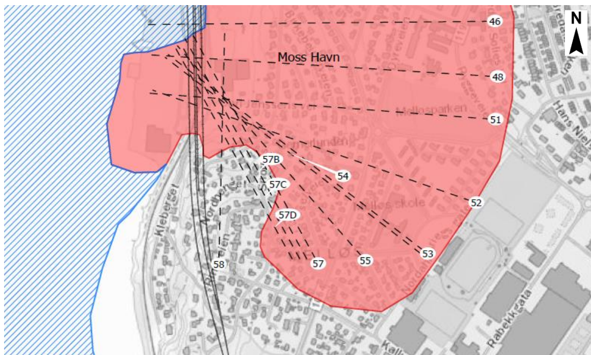
Figur 4-5: Beliggenhet av beregningsnitt på Kleberget. Utsnitt av faresonen Moss Havn vises også. Rød farge viser løsneområde, mens blå farge viser utløpsområde
