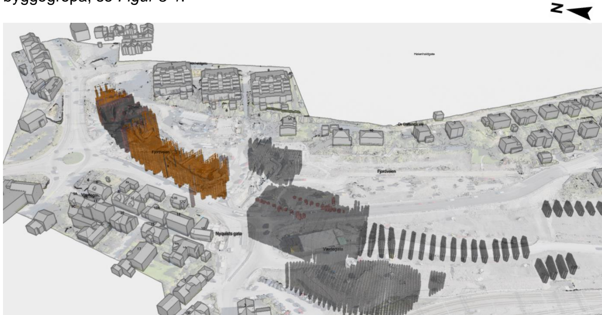
Figur 3-1: Jetpeler som er installert i Kransen Nord, samt kalksementpeler og jetpeler som er installert i Kransen Syd, Kransen Øst og på Stasjonsområdet
