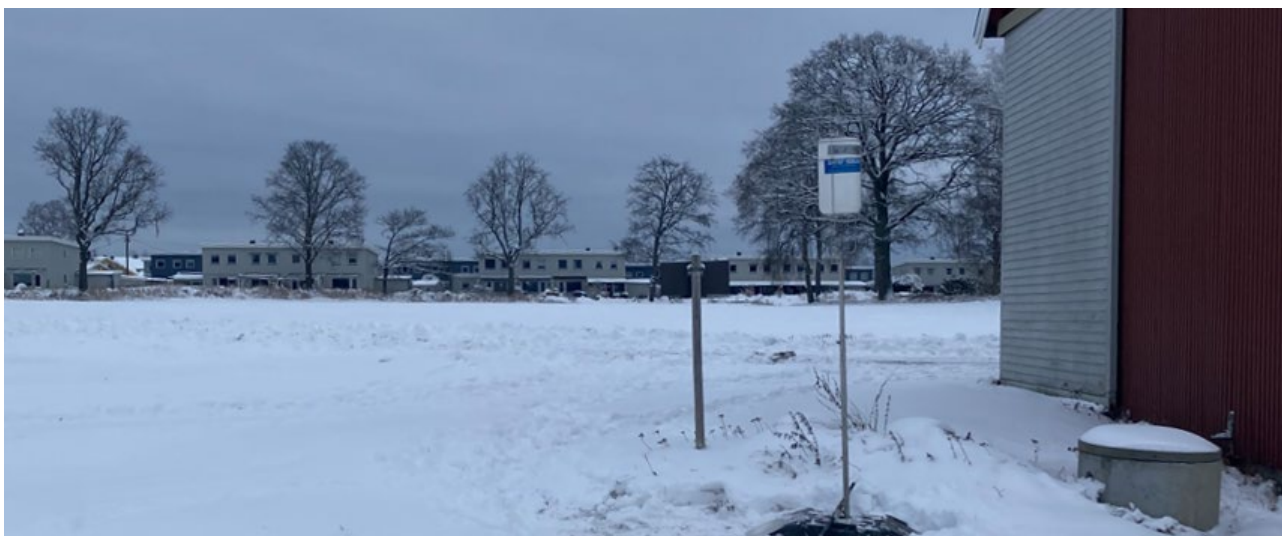
Figur 8. Stasjon for måling av støvnedfall. Foto: Bane NOR.
